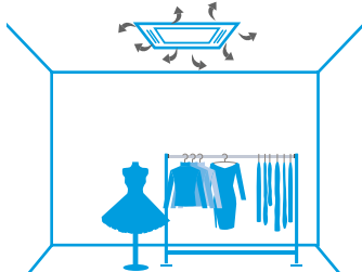
Rozkład powietrza z zabrudzonym filtrem
